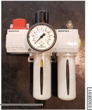
Fig. 82: Unité de traitement d'air
